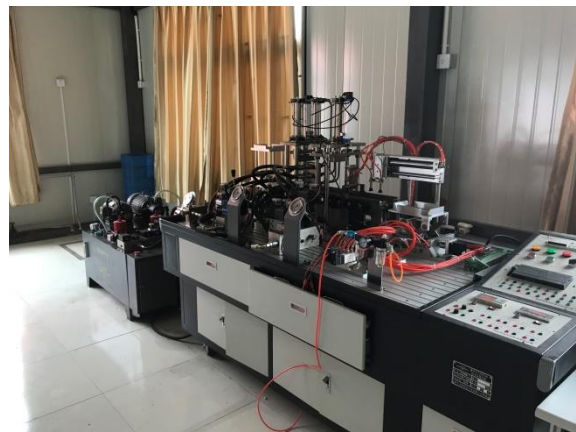
(4) 机械综合实训室 1 间。(购置 2 套液压与气压综合实训考核装置，用于机械安装与可编程控制综合实训)
